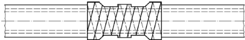
Γ) Δεύτερο στρώμα της ταινίας περιέλιξης στη σύνδεση
